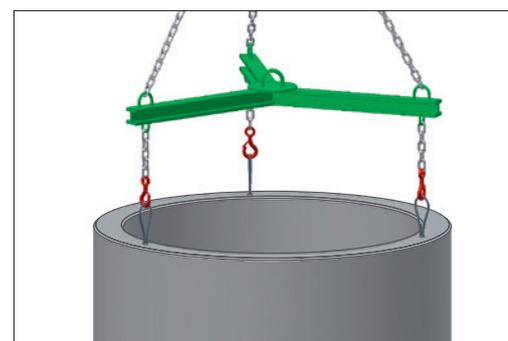
Bauteile mit Seilschlaufen
